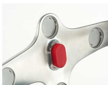
Ilustração do posicionamento do marcador refletor nos espaços existentes no rastreador frontal.
